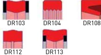
**Application:** Joint de tige hydraulique a double action
